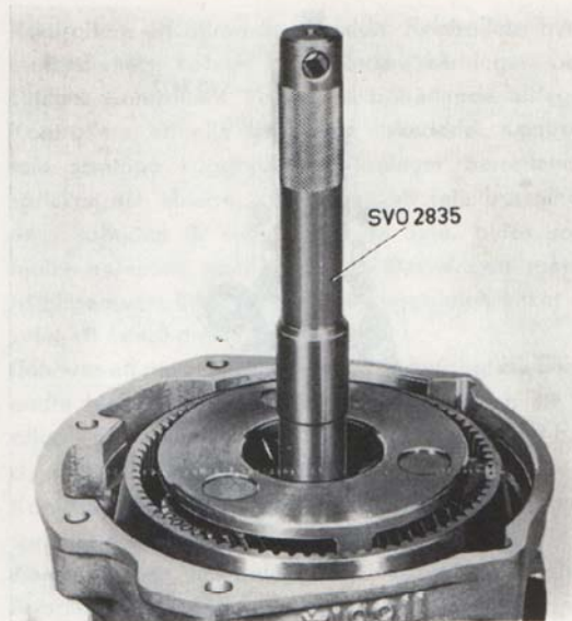
Bild 32. Montering av planethjul, II
